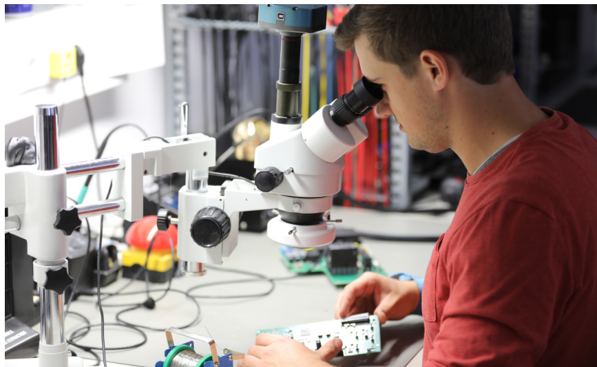
Prüfung einer elektronischen Baugruppe unter dem Mikroskop auf mögliche Lötfehler. (Foto: Burger Engineering GmbH).
