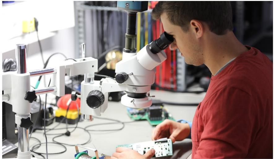
Prüfung einer elektronischen Baugruppe unter dem Mikroskop auf mögliche Lötfehler. (Foto: BURGER ENGINEERING GmbH & Co. KG).
